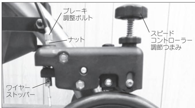
使用していると、ブレーキワイヤーが伸びてきたり、キャスト等の摩耗により、ブレーキの効きが悪くなりますので、適時ブレーキの調整を行って下さい。
