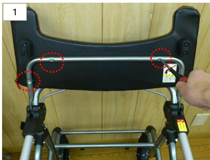
②左右のクッションゴムを取り付けてあるボルトをプラスドライバーで外します。
