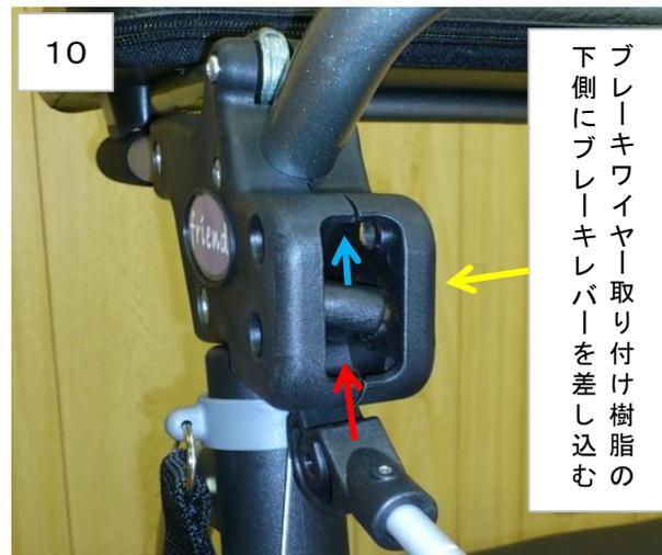
⑪ ブレーキレバーの先端樹脂を写真の様に差し込みます。
