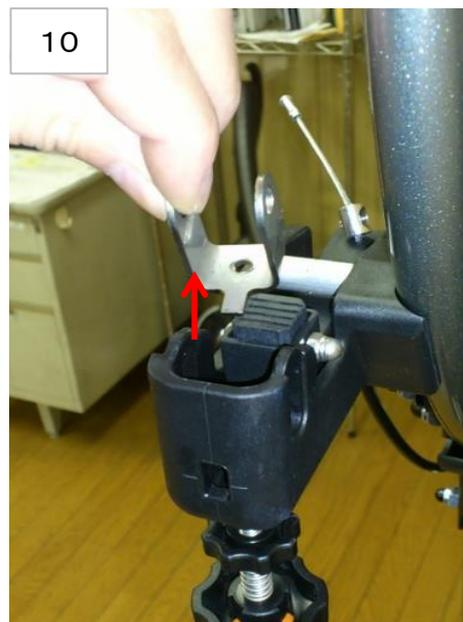
⑪ゴムローラー取り付け台座の下にある写真のワッシャーを工具でつかみ取り外します。
